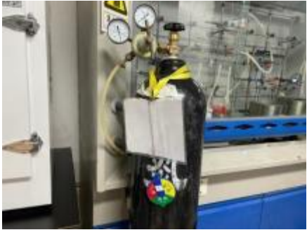
钢气瓶状态牌损坏
