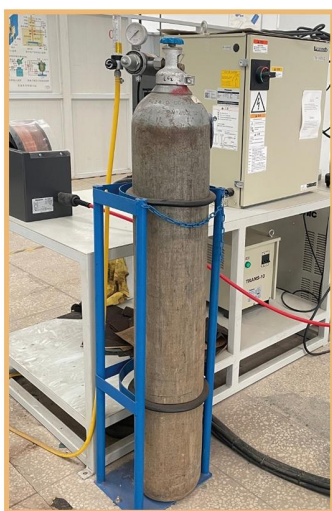
图22 气瓶固定在支架上使用
