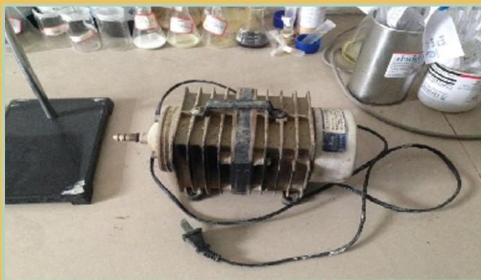
**事故原因:**实验过程中，使用机械电子泵加压，因充气泵压力过大，发生硅胶柱玻璃管结合处有机溶剂突然溢出，由于溶剂属于低熔点，发生燃烧。
