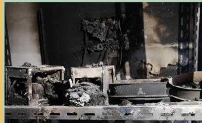
**事故情况:**2023年2月17日凌晨4点12分，屯溪路校区老土木楼一楼106给排水实验室，一台蠕动泵在运行中出现火花，造成该套实验台架局部烧毁。
