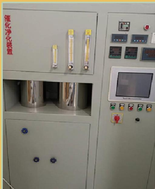
事故原因:设备电线老化高温下运行,缺少定期维修保养。
