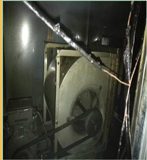
**事故情况:**2018年3月2日，我校汽车尾气处理环保研究所，一汽车实验台架系统冷却机组在实验过程中，发生**燃烧事故**。
