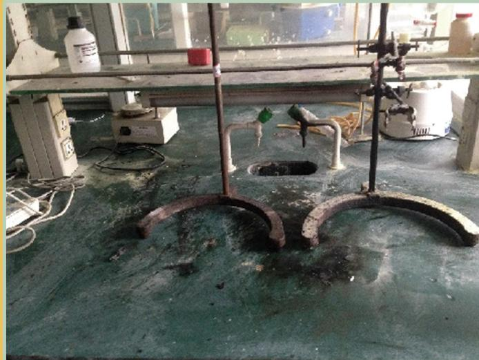
**事故情况:**2016年4月20日中午，原医学工程学院研究生程\*\*在昇华楼604实验室通风橱中，进行有机溶剂柱层析实验。出现着火燃烧现象，导致学生左右双手严重烧伤（事后植皮手术），充气泵被烟尘熏黑，通风橱内部分阻燃材料高温变形等现象。
