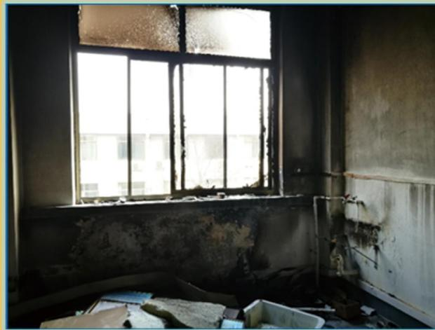
**事故情况:**2017年2月24日中午，材料科学与工程学院科研人员做零件烘干时，无人值守，导致干燥箱温度积累，使周边的实验台和桌椅发生燃烧，造成安全事故。
