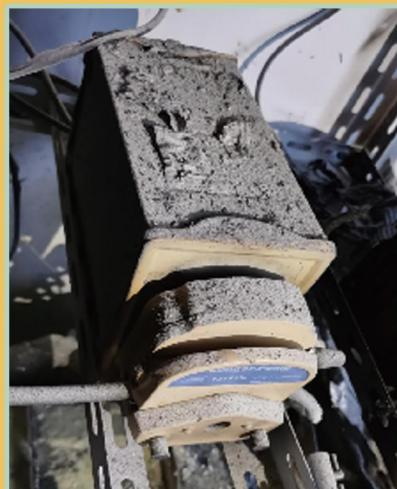
**事故原因:**实验需24小时不间断运行，但无人监守；同时该蠕动泵为2006年购置，局部线路老化，没有及时维护保养和检修，长时间运行造成电机过热，发生燃烧。
