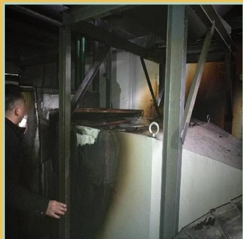
**事故原因:**实验过程中，使用机械电子泵加压，因充气泵压力过大，发生硅胶柱玻璃管结合处**有机溶剂突然溢出**，由于溶剂属于**低熔点**，发生**燃烧**。
