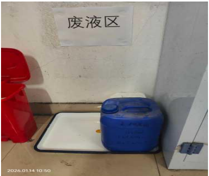
危废暂存区地面张贴警示线，墙上张贴废物暂存区标识，废液桶下面加装防渗漏托盘，废液桶张贴废液标签
